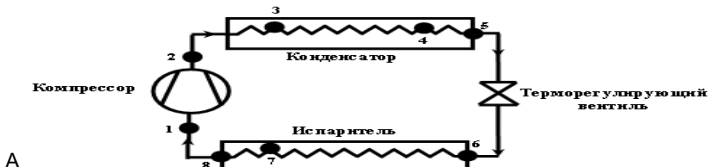
Рис.1 Схема водо-охлаждающей установки каландровой линии
