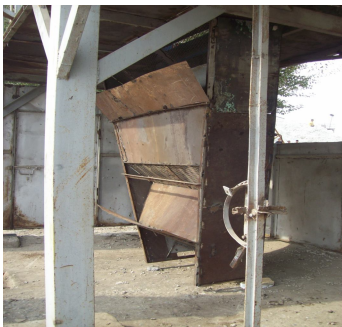
Рис 2. Экспериментальный образец вертикального очистителя в производственных условиях на Чинабадском хлопкоочистительном заводе
