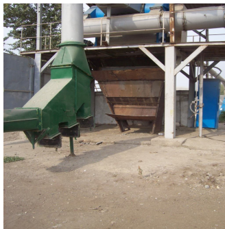
Рис 2. Экспериментальный образец вертикального очистителя в производственных условиях на Чинабадском хлопкоочистительном заводе
