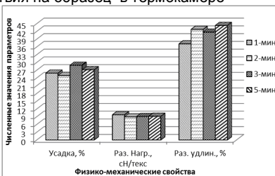
Рисунок 3 - Графическая зависимость физико-механических свойств КВУН от времени воздействия на образец в горячей воде
