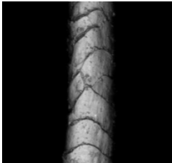
Рис. 1. Микрофотографии волокна: исходное (а), обработанное дисперсией алюмосиликатов (б).
