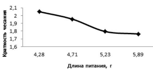
Рис.2. Кратность чесания гребенным барабанчиком
