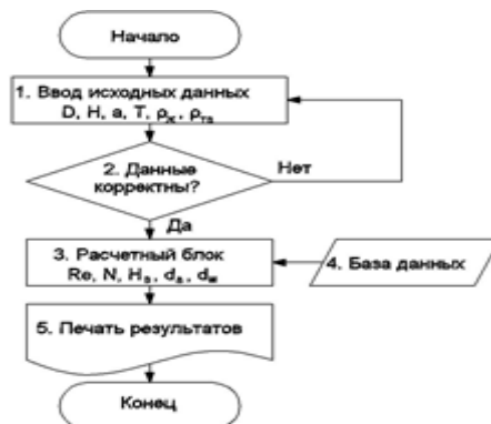
Рис. 1 – Блок-схема расчета определения оптимальной конструкции перемешивающего устройства:
