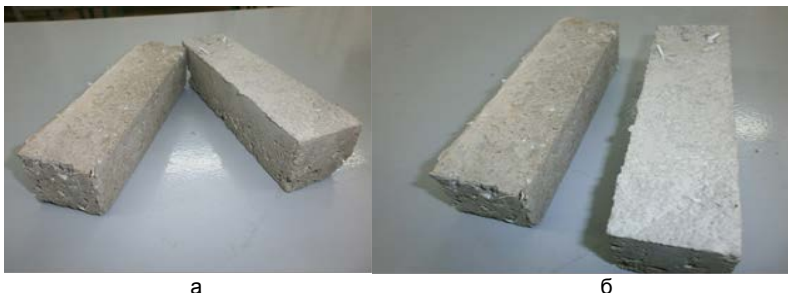
Рис.1 Образцы – балочки из мелкозернистого бетона с включением поливинилхлоридной стружки в количестве, а) 1% от массы б) 2 % от массы
