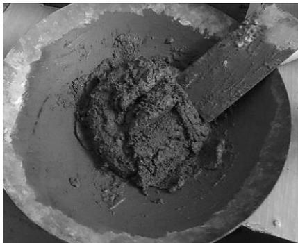
Рис. 2 Бетонная смесь с пластифицирующей добавкой
