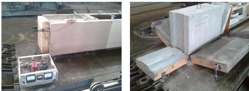
Рис. 1 Внешний вид опытно-промышленной установки в ходе ЭТО токами повышенной частоты (13,3 кГц) с использованием транзисторного источника питания мощностью 4,5 кВт (на переднем плане – слева) и после завершения обработки с распалубкой готового изделия (справа)
