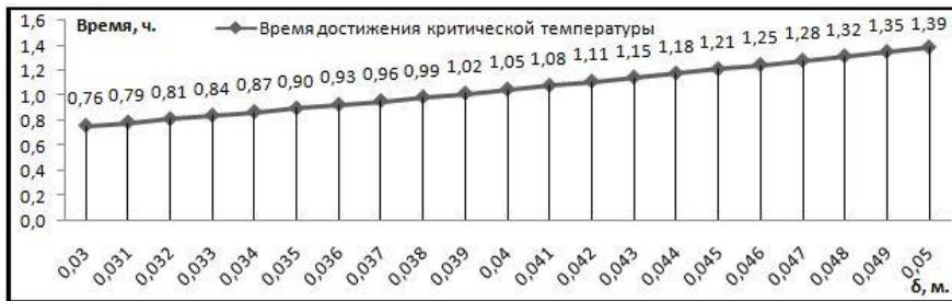
Рис.1 Зависимость времени наступления предела огнестойкости от толщины защитного слоя бетона (δ)
