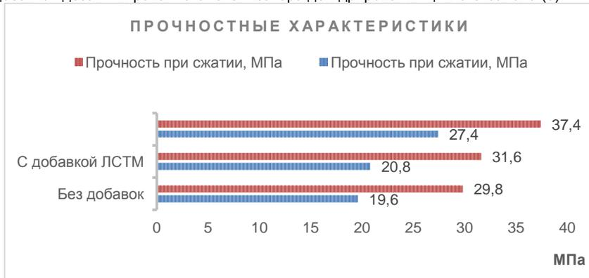
Исследования показали, что положительное влияние добавок на свойства бетона марки В22,5 очевидно. Увеличение прочности образца с добавкой ЛСТМ и НТК (дезактив) через 24 ч при тепловлажностном режиме твердения по сравнению с образцом без добавки и образцом с добавкой ЛСТМ составляет 37,8% и 31,7% соответственно. На 28 суток повышение прочности составляет 26,5% и 18,3% соответственно.
