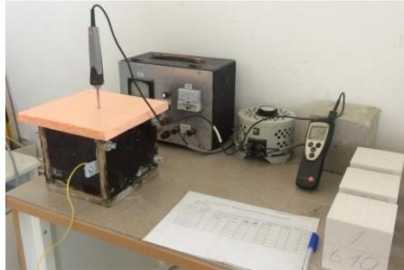
Рис. 2 Внешний вид лабораторной установки для ЭТО токами повышенной частоты образцов газобетона 150x150x150: слева – опалубка с образцом в камере повышенного давления; справа – источник питания с опалубкой и готовыми образцами.
