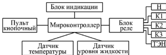
Рис. 1. Структурная схема автоматического управления установкой для получения СОЖ
