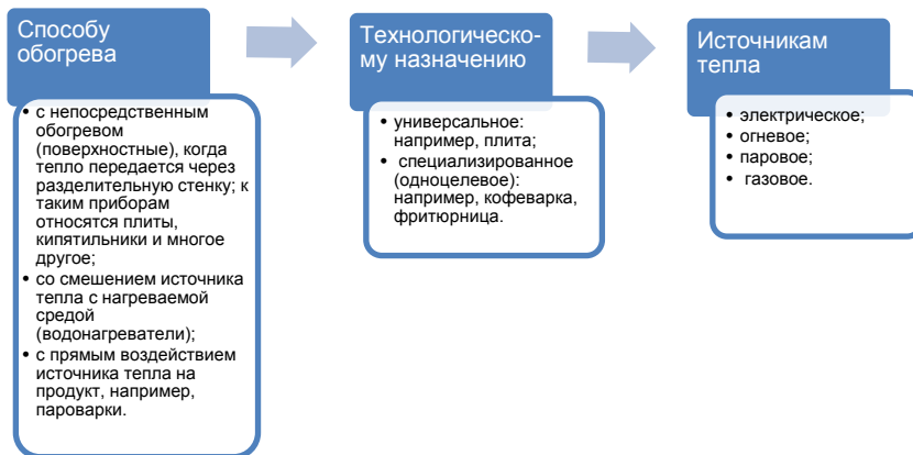
Рис. 1 Признаки деления оборудования горячего цеха на группы
