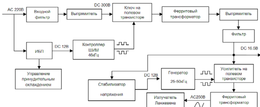
Рис.1 Схема ультразвукового генератора с импульсным источником питания
