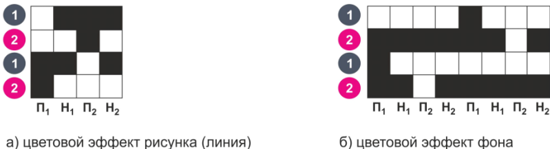
Рис. 1 Модельные переплетения для изготовления шарфа на ткацком станке
