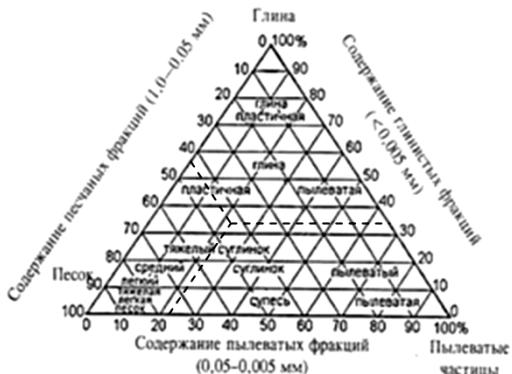
Рис. 1. Гранулометрический состав глинистого сырья калтагизского месторождения
