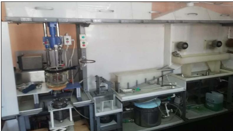
Рис. 1 Пилотная установка – узел полимеризации и формования волокон
