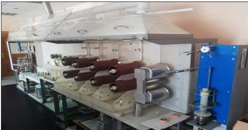
Рис. 2 Пилотная установка – узел намотки комплексных нитей
