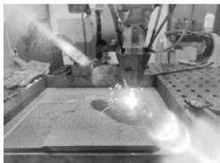
Рис.4а Процесс лазерной наплавки на образцах-свидетелях
