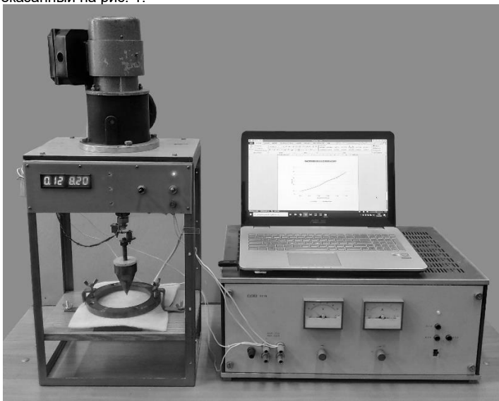
Рис. 1. - Стенд для испытания геосинтетических полотен на динамическое продавливание
