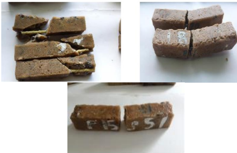
Рис.1 - Характерные виды разрушения полимербетонных образцов: а - со стеклопластиковой арматурой, б - с металлической арматурой; в - неармированных образцов
