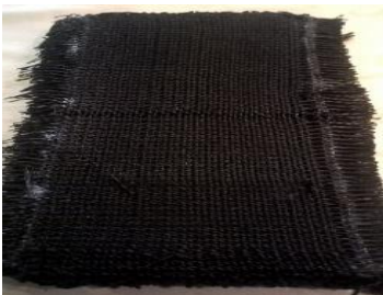
Рис.2. Образец трехмерной ткани из углеродного волокна, полученная по технологии 3D ткачества на экспериментальной установке
