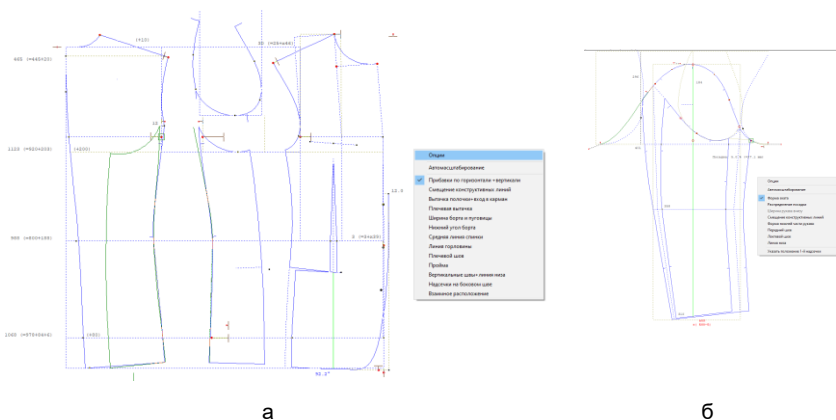
Рис. 1. Базовая интерактивная конструкция мужского пиджака в GRAFIS CAD: а - стан; б - двухшовный рукав
