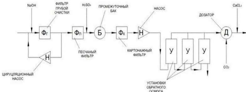
Рис. 1. Схема водоподготовки с использованием обратноосмотических установок
