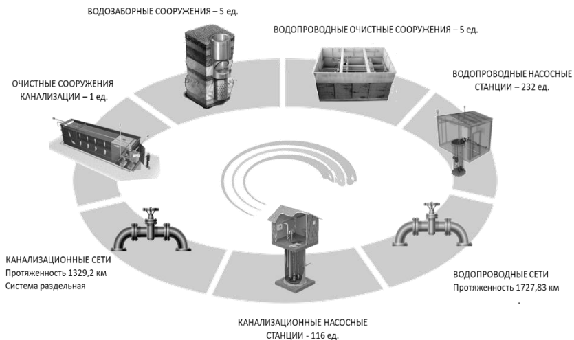
Рис. 1. Состав систем водоснабжения и водоотведения
