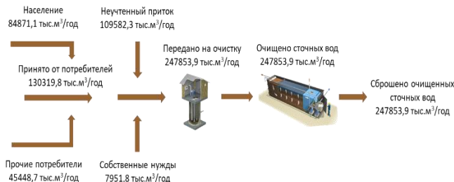
Рис. 3. Баланс системы водоотведения города
