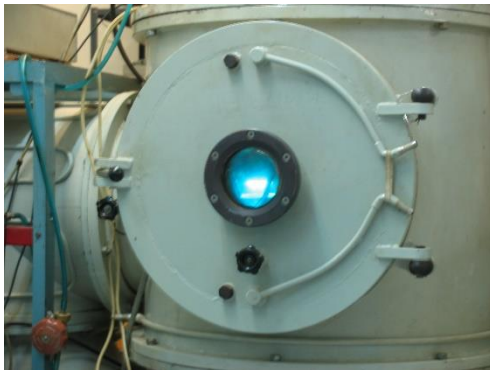
Рис. 1. Работаящая лабораторная магнетронная установка планарного типа
