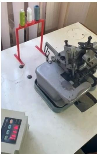
Рис. 1. Общий вид краеобмёточной машины 51 класса
