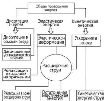
Рис. 1. Схема преобразования общей проводимой энергии в фильере при формировании волокон
