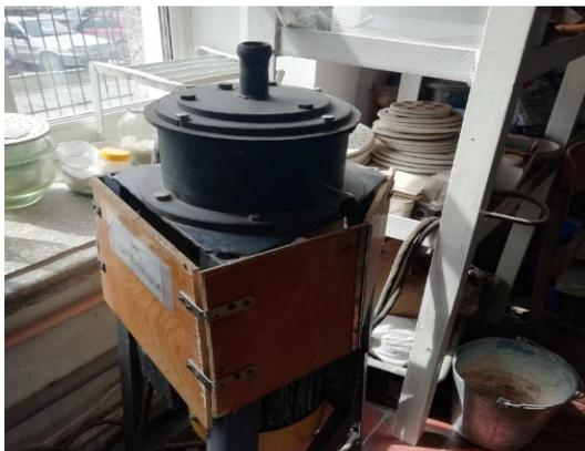
Рис. 1. Роторный аппарат модуляции потоков
