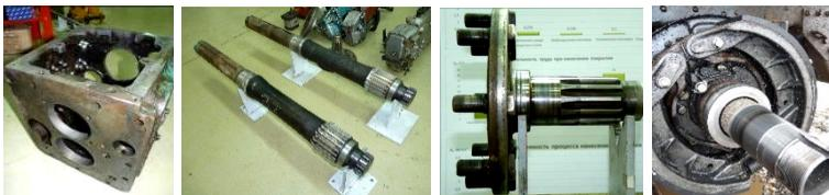
Рис. 1. Примеры деталей, достигших предельного износа: корпус коробки передач, полуоси, цапфы, ступицы тракторов, чулки ведущих мостов
