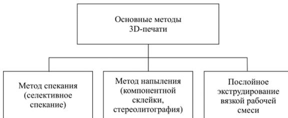
Рис. 1. Основные методы 3D-печати, используемые при строительстве
