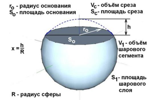
Рис. 1. Расчётная схема и геометрические величины
