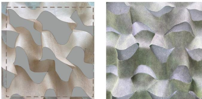
Рис. 2. Фотографии макетов маскировочных сеток в растянутом состоянии
