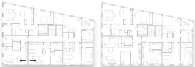
Рис.1. Генерация новой планировки после перемещения стены в новое положение в программе Finch 3D
