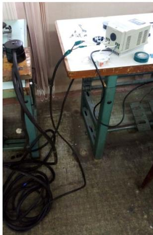
Рис. 3. Подключение преобразователя частоты к электродвигателю краеобметочной машины 51 класса.
