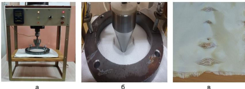
Рис. 1. Действующий макет измерительной установки: а — внешний вид; б — продавливание пробы конусом; в — состояние тканого ГТМ после испытаний
