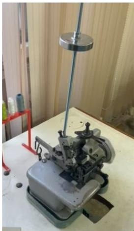
Рис. 2. Механический поглотитель вибраций
