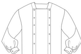
Рис. 2. Технический рисунок модели блузы со съемной конструктивно-декоративной вставкой переда
