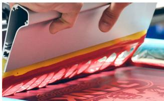
Рис. 2. Трафаретный способ нанесения рисунка
