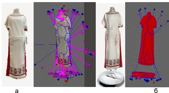
Рис. 1. Результат трёхмерного сканирования при помощи LiDAR: а – мало света, б – больше света
