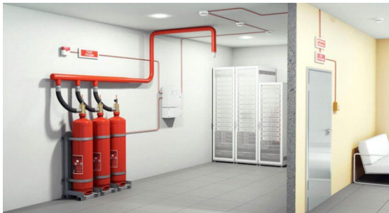
Рис. 1. Пример расположения установки
