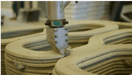
Рис. 1. Выдавливание смеси из сопла 3D-принтера
