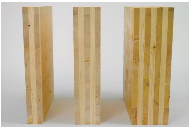
Рис. 1. Реальное изображение трёх типов деревянных клееных панелей
