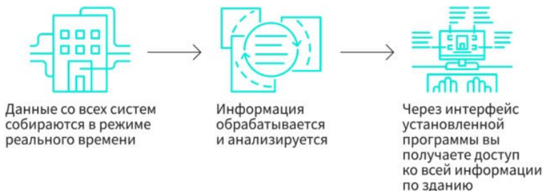
Рис. 1. Схема работы цифрового двойника в упрощенном виде [4]
