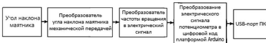
Рис. 2. Структурная схема системы измерения параметров трения на основе преобразования угла отклонения маятника в цифровой код платформы Arduino
